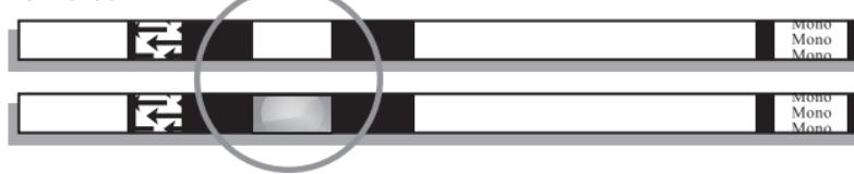
Si au bout de 5 minutes aucune bande de contrôle rouge n'apparaît ou que la couleur de fond rend impossible la lecture de la bande de contrôle rouge, le résultat n'est pas valide. Dans ce cas, renouveler le test sur une autre bandelette de test ou appeler l'assistance technique de Sekisui Diagnostics au (800) 332-1042 (États-Unis uniquement) ou au (781) 652-7800.
