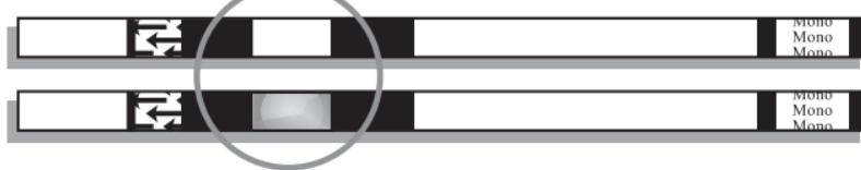
Se dopo 5 minuti non appare una linea di controllo rossa o se il colore dello sfondo rende impossibile la lettura della linea di controllo rossa, il risultato non è valido. In questo caso, ripetere il test su un nuovo stick del test o telefonare all'Assistenza tecnica Sekisui Diagnosticsal numero (800) 332-1042 (solo Stati Uniti) o (781) 652-7800.
