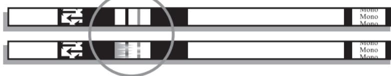
En blå testlinje og en rød kontrollinje er et positivt resultat for detektion af heterofil antistof mod infektiøs mononucleosis. Bemærk, at den blå linje kan have en hvilken som helst blå nuance og kan være lysere eller mørkere end linjen på billedet.
